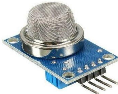
Figure 2.20 Capteur de qualité de l'air MQ-135
