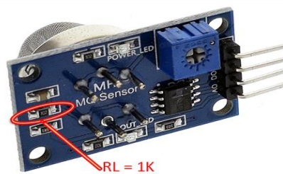
Figure 3.7 Remplacement R_L par une résistance de charge 10\text{-}22\text{K}\Omega
