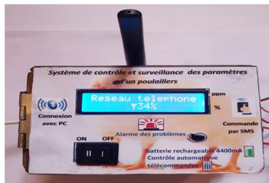
Figure 3.20.b l'affichage de l'état du réseau
