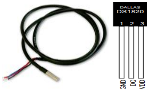
Figure 2.21 Capteur de Température DS18B20
