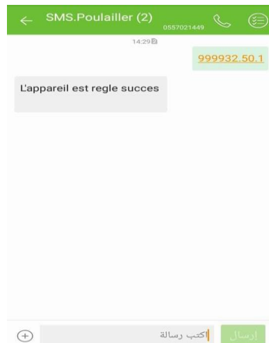
Figure 3.26 L'appareil envoie un SMS afin de confirmer la configuration
