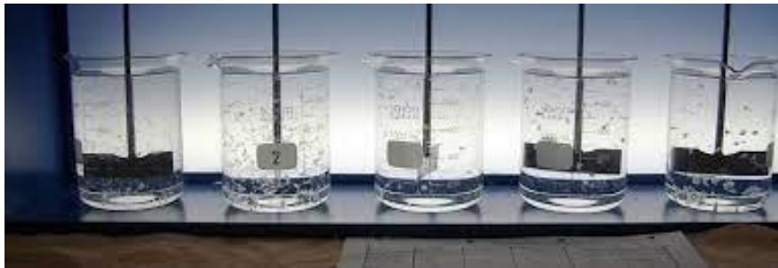
Figure II.1 : Phénomène de la coagulation- Floculation
