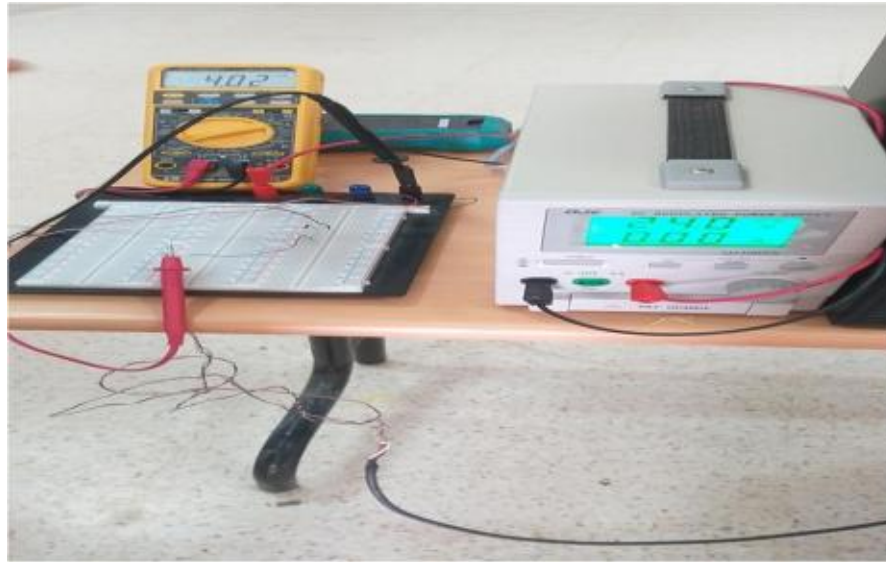
Fig.III. 5. Test du bon fonctionnement du transmetteur de pression.
