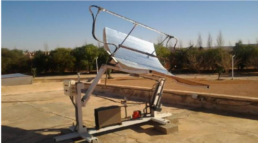
Figure I.34 : le prototype réalisé de PTC avec le nouveau système de suivi du soleil [135].
