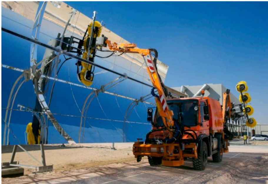
Figure I.23 : Camions de nettoyage pour nettoyer les miroirs réfléchissants dans le champ solaire de Shams-1 [95].
