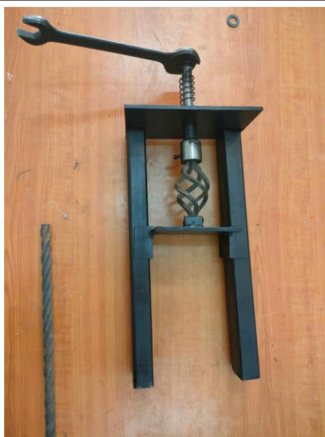
Figure 4.8 : torsadeuse manuelle avec la pomme de pin.
