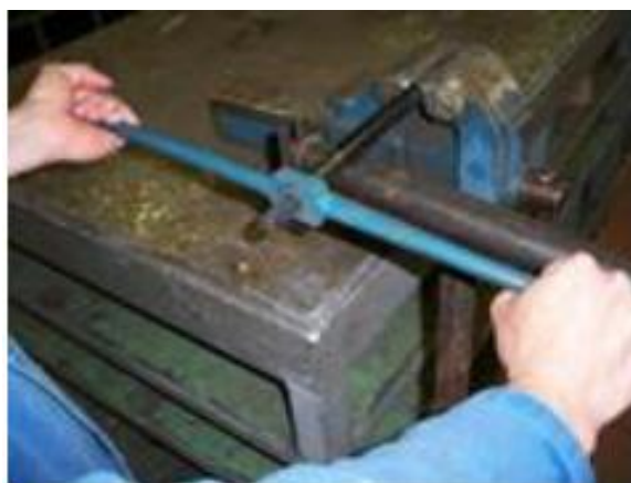
Figure 3.7: Torsadage manuelle à l'aide D'une servante réglable.
