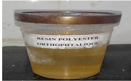
الشكل (34): نوع من الراتنج (البوليستر الأورثوفتاليك).
