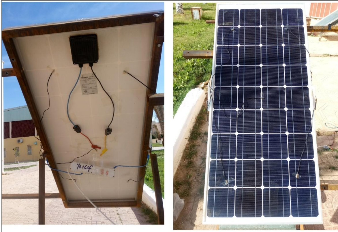
Figure II.6 : Installation des sondes de températures sur le panneau photovoltaïque non dégradé.
