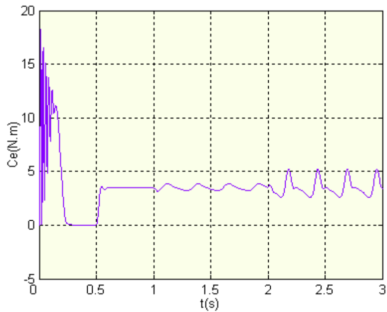
Figure (III.9): Couple au démarrage, en charge puis lors de la rupture des barres
