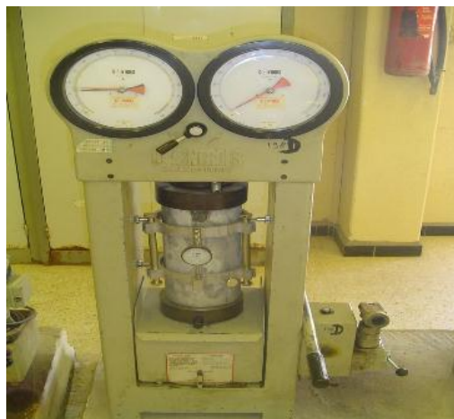
Fig.II.3 : Dispositif pour mesurer le module élastique [23].
