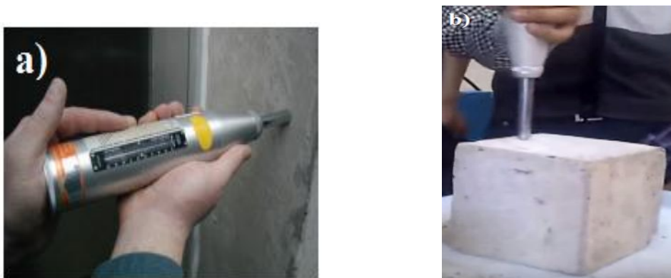
Figure II.7 : a) Mesure sur surface béton, b) sur éprouvette cubique (10*10*10) cm 3 [19].
