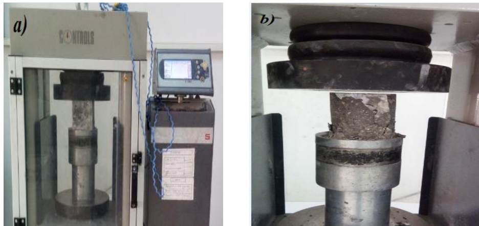
Figure IV.4 : Essai compression :a) machine et éprouvette, b) éprouvette détruite.
