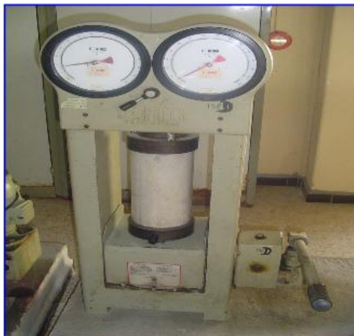
Figure II.1 : Dispositif pour mesurer la résistance à la compression [23].
