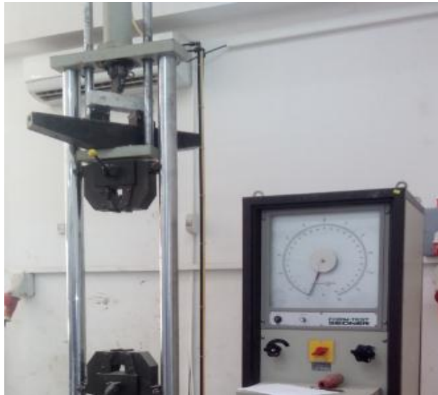
Figure II.2 : Dispositif pour mesurer la résistance à la traction par flexion.
