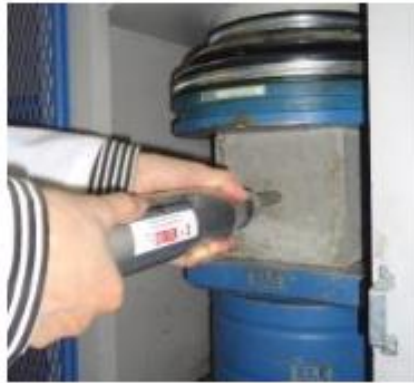
Figure IV.6 :Principe de l'essai scléromètre.
