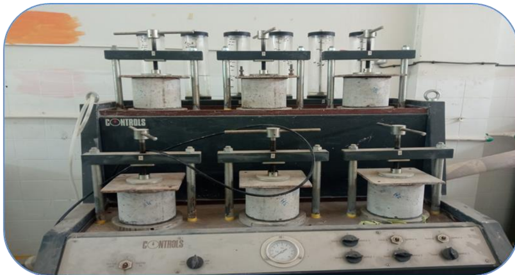
Figure II-7 : perméabiliserai permettant les tests de six éprouvettes
