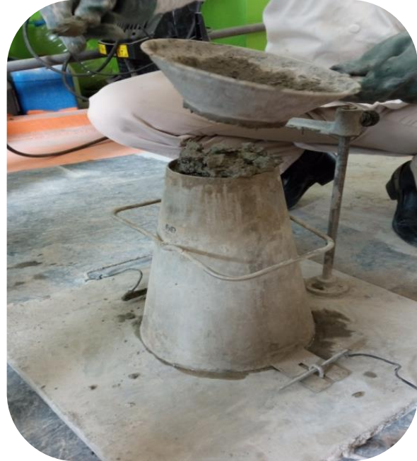
Figure III.16 : Affaissement au cône d'abrams
