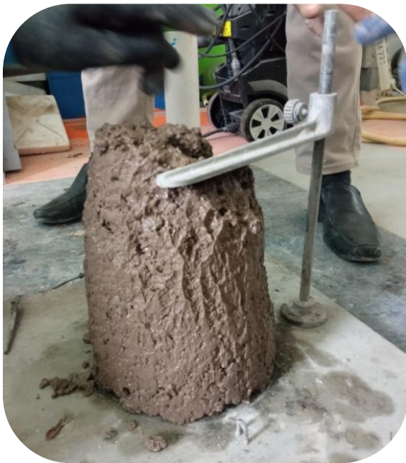
Figure III.16 : Affaissement au cône d'abrams
