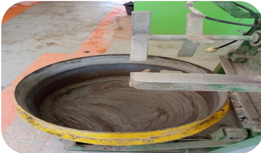
Figure III.15 : Le malaxage de béton
