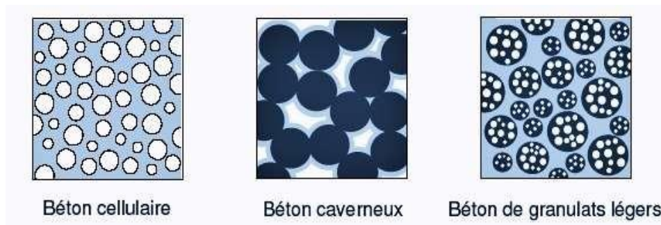
Figure I.1 : Représentation schématique des différents types de béton léger [6].
