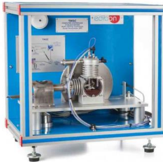
Figure 1 : Dispositif expérimental du moteur de Stirling
