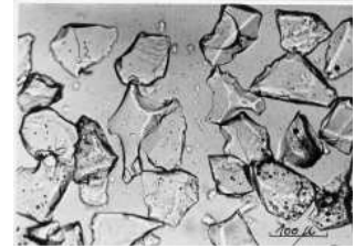
Figure 1 : Laitier granulé de haut fourneau vu au microscope [6].
