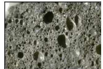
Figure 2 : Pouzzolane volcanique vu au microscope [6].
