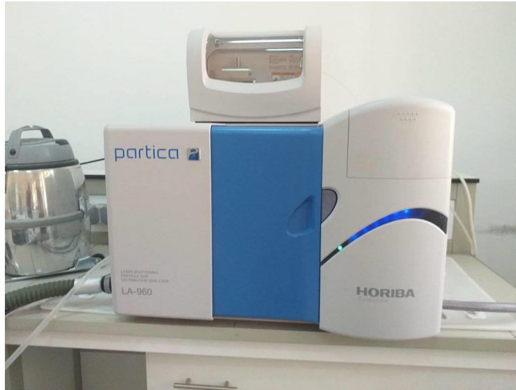
الشكل 8.3: جهاز قياس توزيع حجم الحبيبات HORIBA LA-960.
