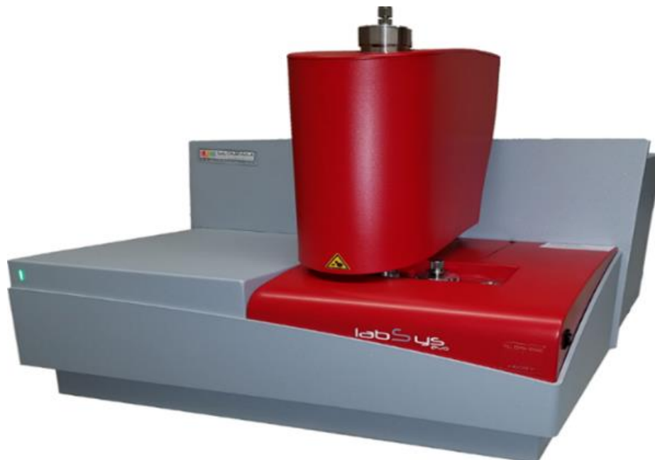
الشكل 3.5: صورة لجهاز التحليل الحراري الكتلي التفاضلي من نوع (LABSYSEVO).
