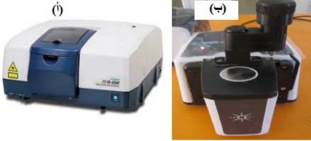
الشكل 3. 4: صورة لجهاز: (أ) FTIR من نوع JASCO FTIR – 4200 و (ب) نوع AGILENT ATR.
