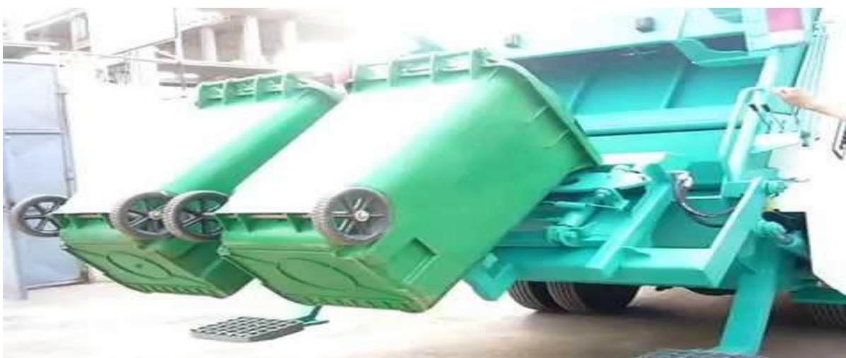
Figure 17: Un benne tasseuse vider les bacs a ordures
