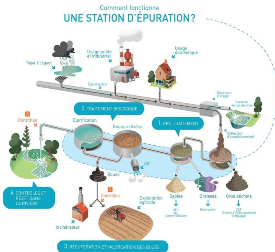
Figure II-7 : Le processus de fonctionnement d'une-station-d'épuration
