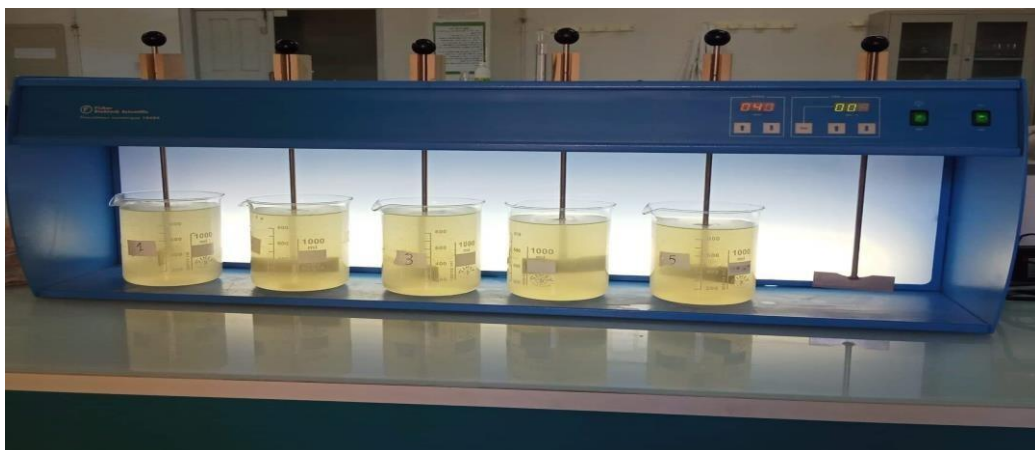
Figure III.3 : Appareil du Jar test(Photo de la STEP de la ville de Bou Saâda)
