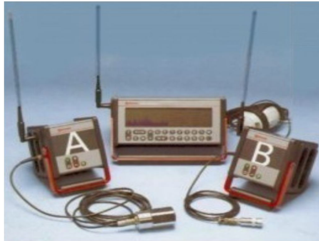
Fig. II.3. Un corrélateur de bruits de fuites est un appareil portatif à microprocesseurs qui repère Précisément et automatiquement les fuites [8]
