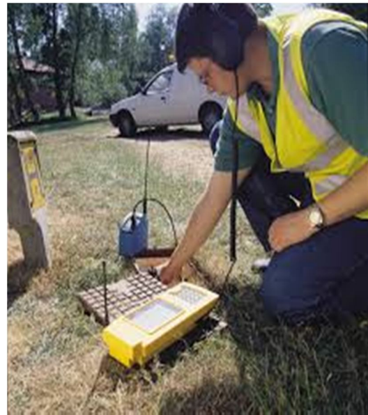
Fig. II.2. Parmi les appareils d'auscultation typiques se trouvent les tiges d'écoute
