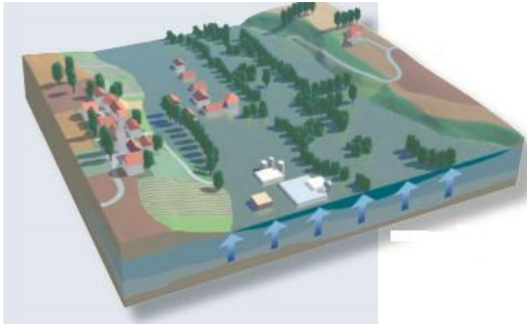
Figure I.1: Inondation par remontée de nappe[5]
