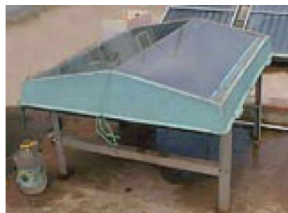
Figure IV.5: présentent le principe et l'exemple d'un distillateur solaire à effet de serre
