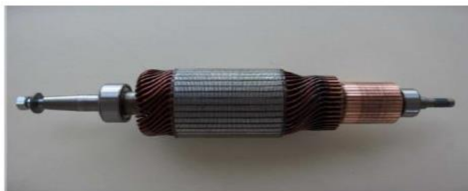
Figure 3.2 Induit (Rotor) d'une MCC.
