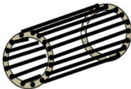
Figure 5.2 Schéma d'un rotor à cage
