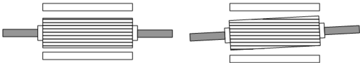
Figure (II.5) : Excentricité statique et dynamique.
