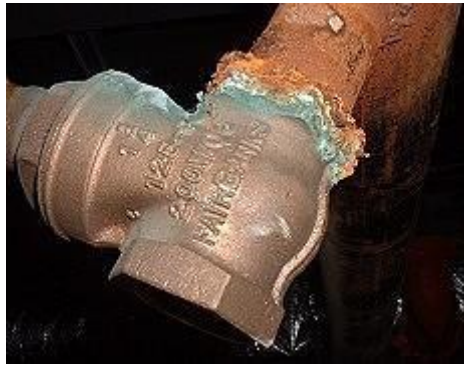
Figure I.3 Corrosion galvanique résultante d'un assemblage de deux métaux différents : robinet en cuivre et conduite en acier galvanisé[11].
