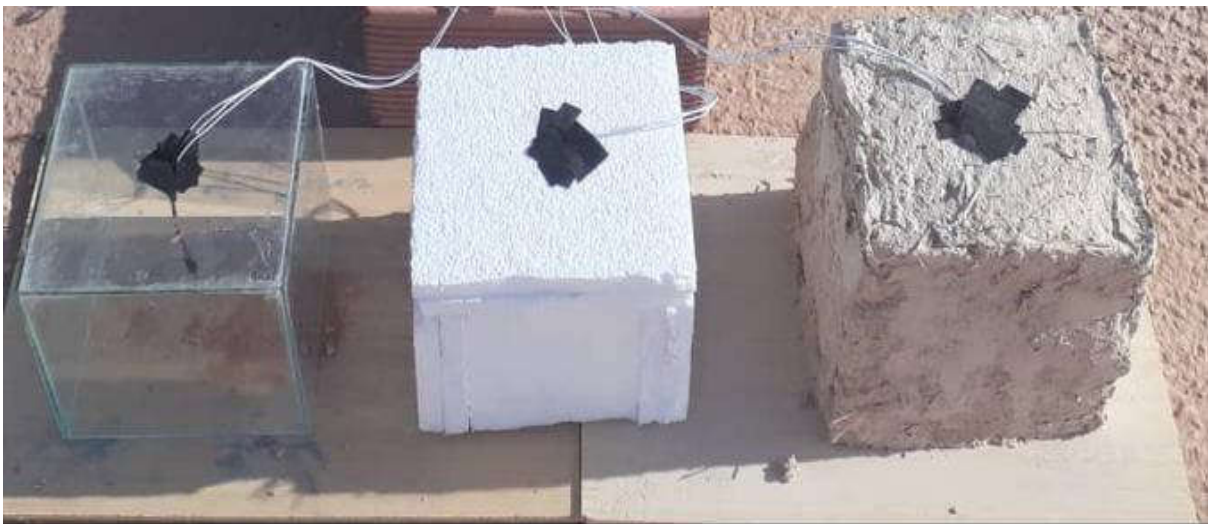
Figure II.5 : Chambres de différents matériaux (verre, polystyrène, et brique ancienne).
