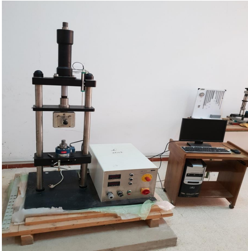
Figure III.4 :Le banc d'essai de la traction unidirectionnelle wp310.
