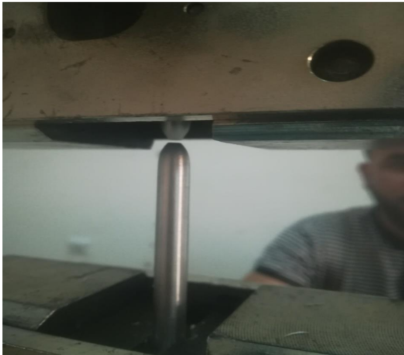
Figure III.8 : Exemple de rupture d'une éprouvette réelle à 10% de compressions.
