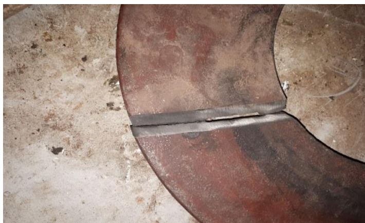
Figure IV.6 : Forme de l'échantillon avant soudage.
