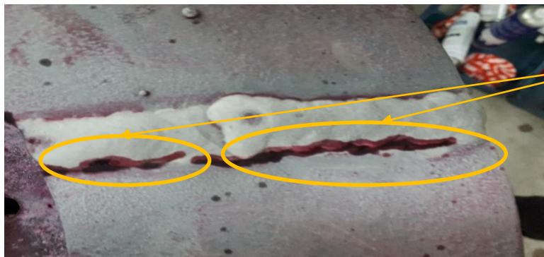
Figure IV.12 : pièce à contrôle par ressuage.
