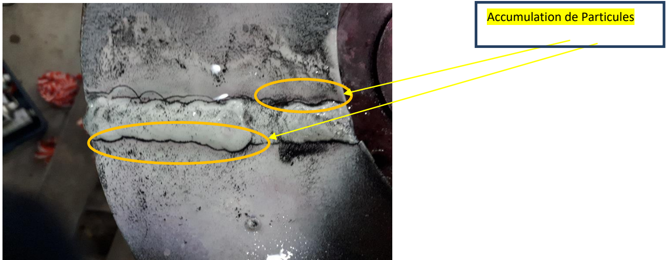
Figure IV.16 : pièce à contrôlé par magnétoscopie.
