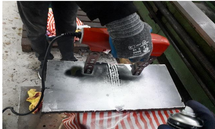
Figure IV.14 : Application du champ magnétique.
