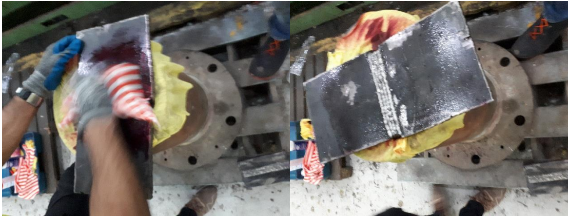
Figure IV.9 : Élimination du produit de ressuage rouge.
