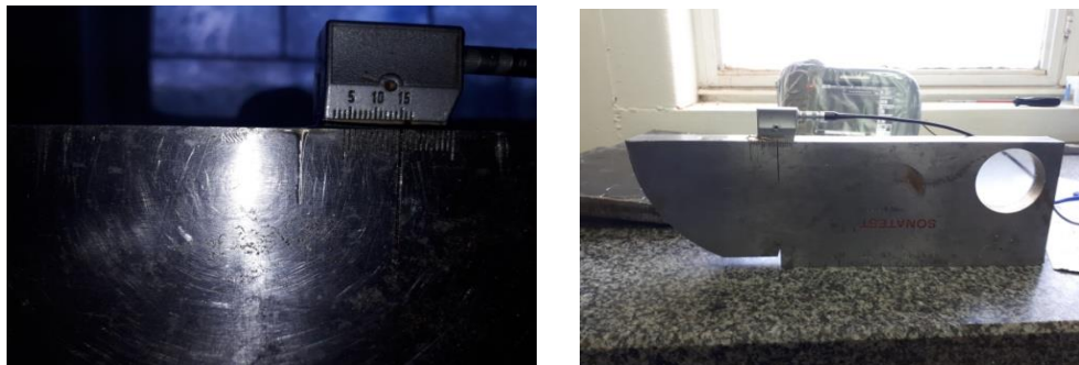
Figure IV.24 : Déterminer la point d'émergence de Palpeur (OT 70^\circ ).
