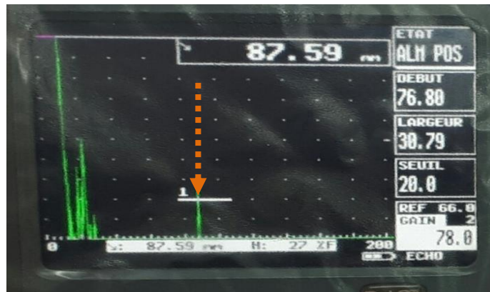
Figure IV.34 : tracé de l'écho de défaut III.
