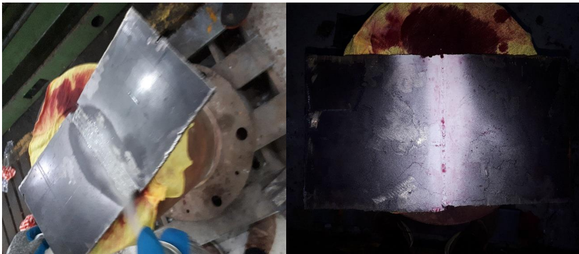
Figure IV.10 : application du révélateur.
