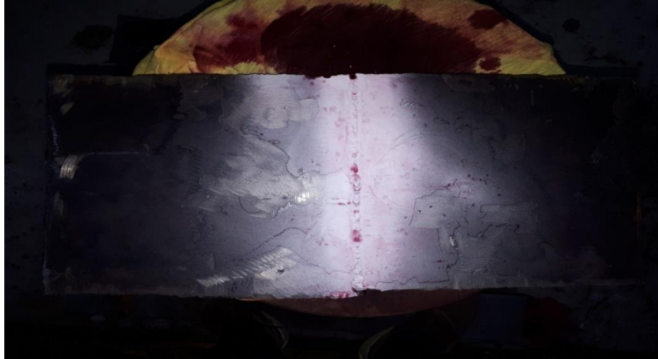
Figure IV.11 : les défauts détectés dans la pièce après ressuage.
