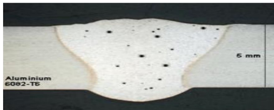
Figure. II.2 : Exemple de soufflures.
