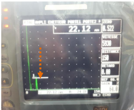
Figure IV.31 : tracé de l'écho de défaut I.
