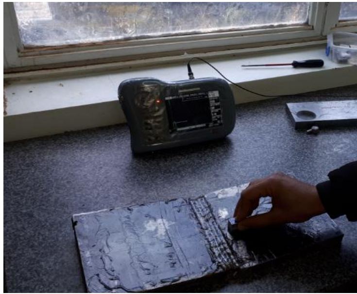
Figure IV.29 : Contrôle la pièce par ultrasons.
