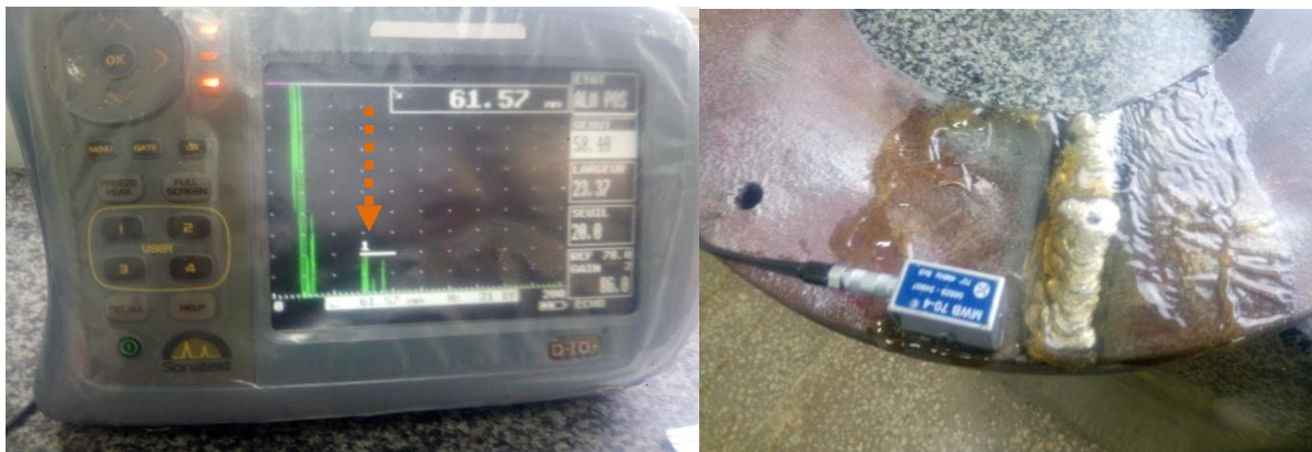
Figure IV.35 : tracé de l'écho de défaut.
