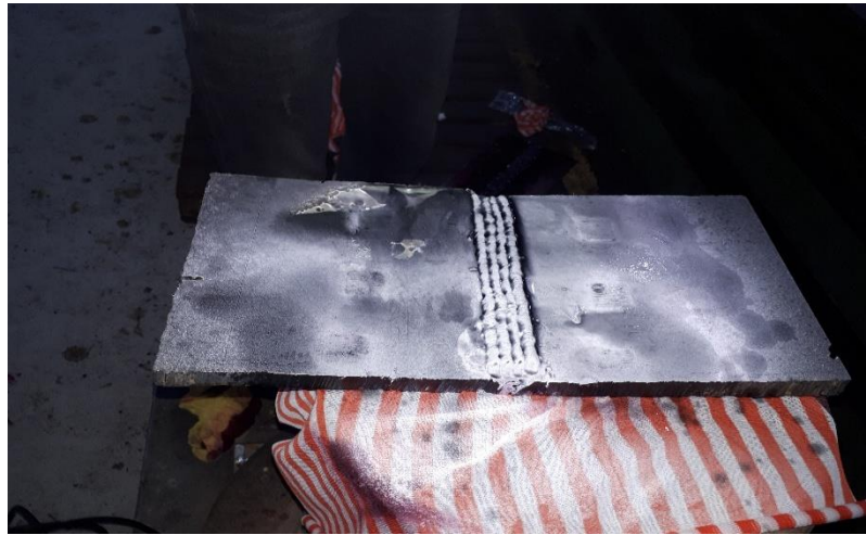
Figure IV.15 : Contrôle par magnétoscopie.
