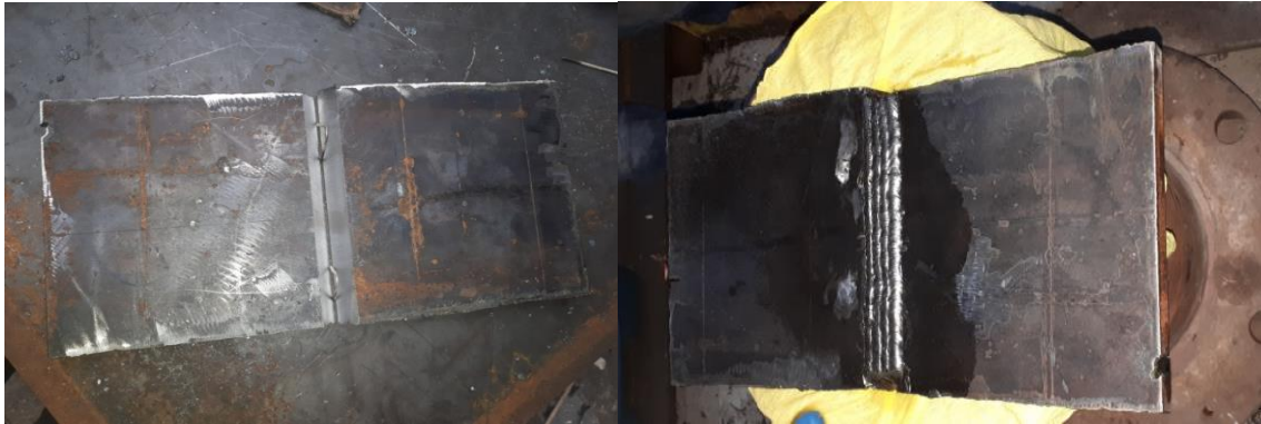
Figure IV.5 : Forme de l'échantillon avant et après le soudage.
