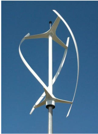
A : éoliennes à axe vertical.
