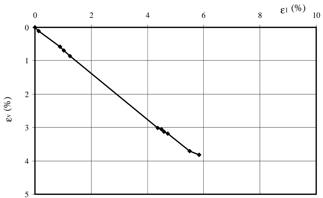
Figure 4.2 Résultats de l'essai triaxial de cisaillement drainé (CID).
