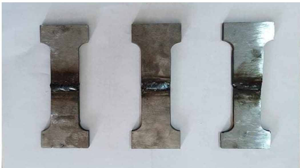
Figure III.5- Les éprouvettes prismatiques après l'exécution de soudage SMAW.
