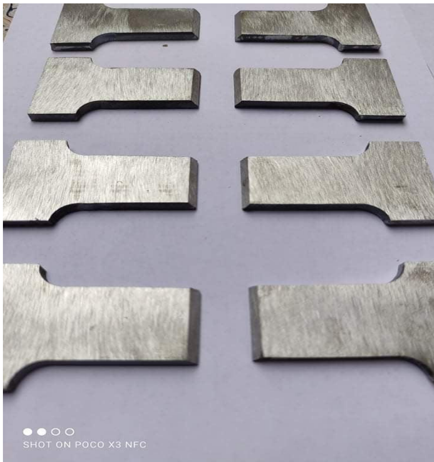
Figure III.2- préparation des éprouvettes à souder pour la traction
