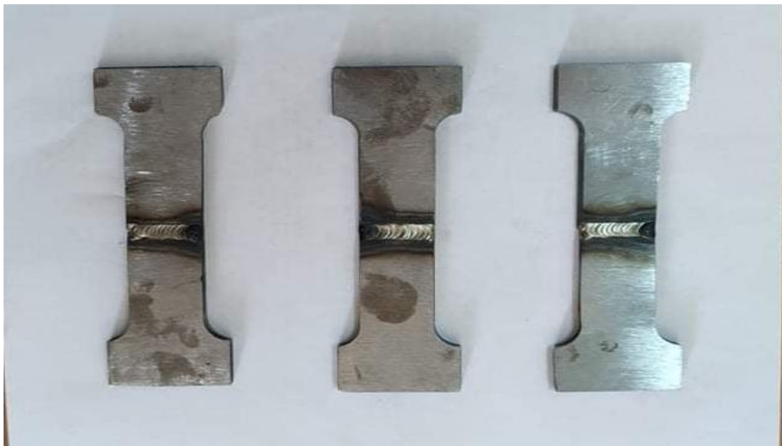
Figure III.7- Les éprouvettes prismatiques après l'exécution de soudage GTAW.
