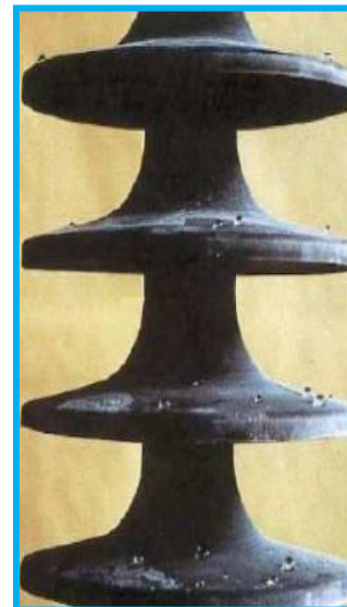
Figure I.13. Vieillessement d'un isolateur composite.
