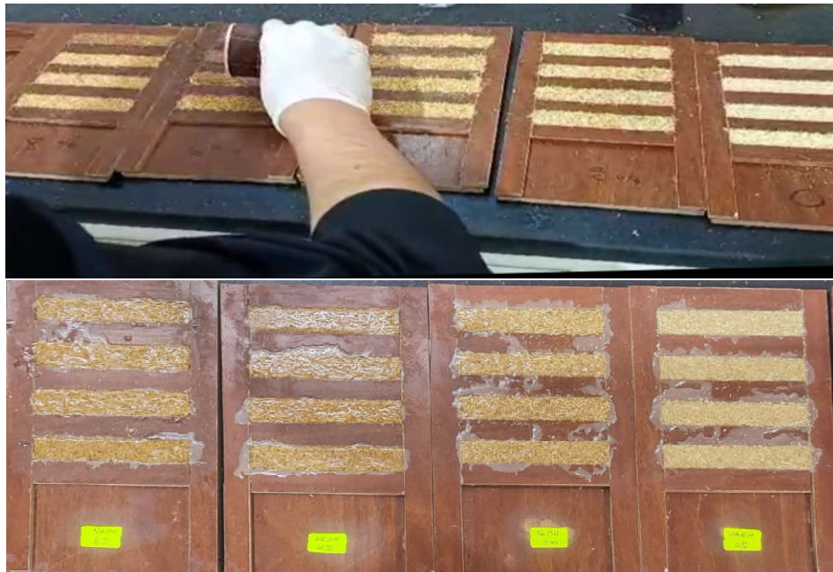
Figure III.11 : Imprégner les fibres avec de la résine.
