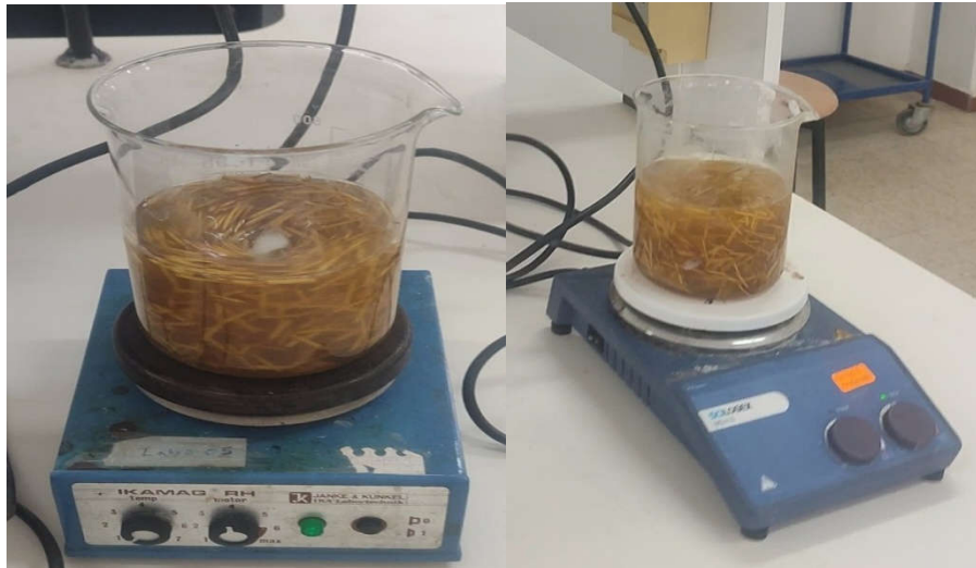
Figure III.5 : Traitement des fibres de Cynodon par NaOH.
