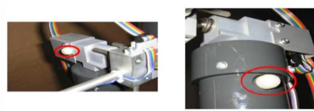
Figure I.7 Vis de fixation de la tige.
