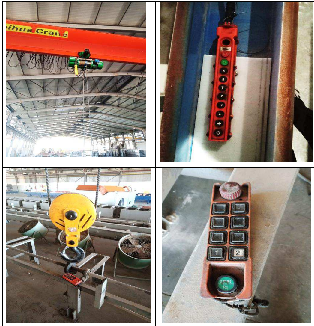
Fig.II.14. les ponts roulants Poids : 20 tonne et la commande manuel [document entreprise].
