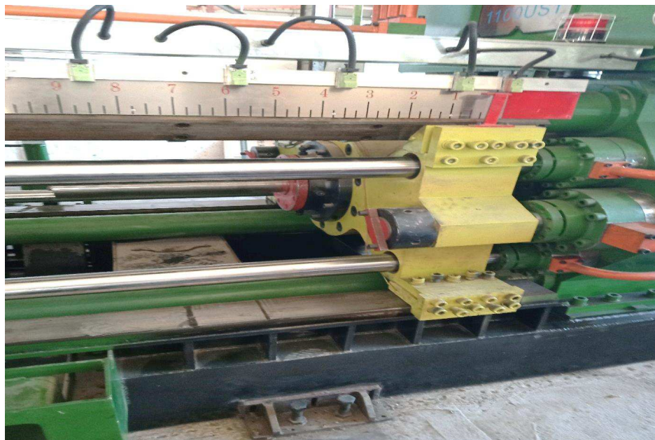
FigI.5.presse hydraulique d'extrusion 1100 ust [ document entreprise ]
