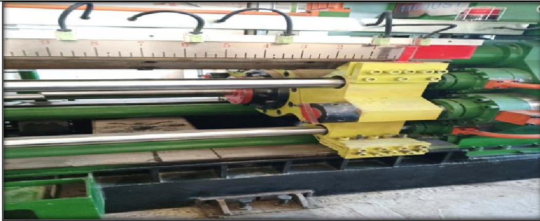
Fig II.9 : Presse hydraulique d'extrusion 1100UST [document entreprise].
