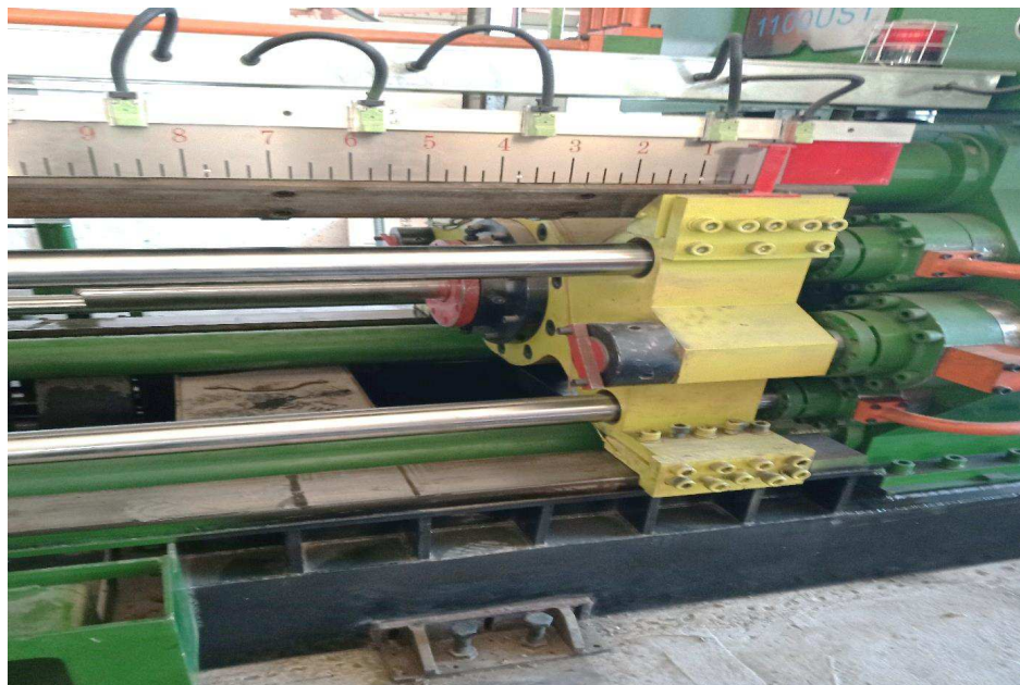
FigI.5.presse hydraulique d'extrusion 1100 ust [ document entreprise ]
