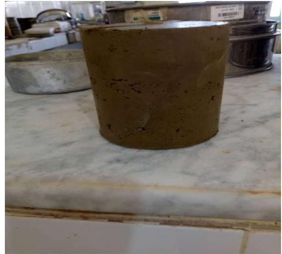
Fig. 3.4 Essai de compactage
