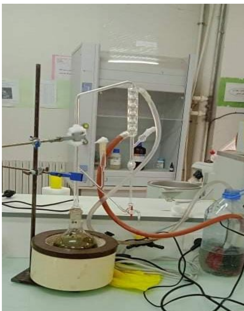
Figure III.2 : Montage d'extraction d'huile essentielle par Clevenger
