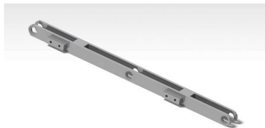
Figure III.19 Bras expose à la résistance de flexion
