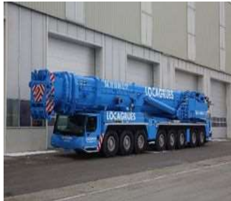
Figure II.5 Grues sur porteur
