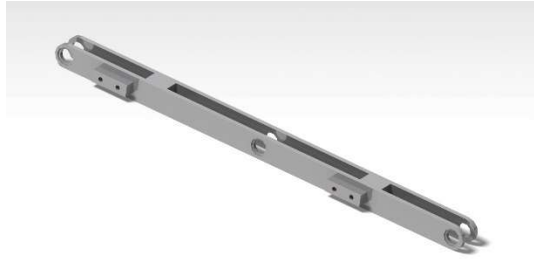
Figure III.11 Bras exposé à la résistance de flexion
