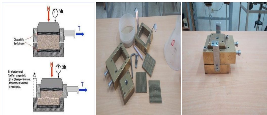
Figure II.1: Principe de la boîte de cisaillement direct.
