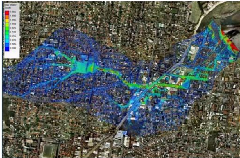
Figure I.12.Exemple d'une carte d'extension spatiale d'une inondation en zone côtière
