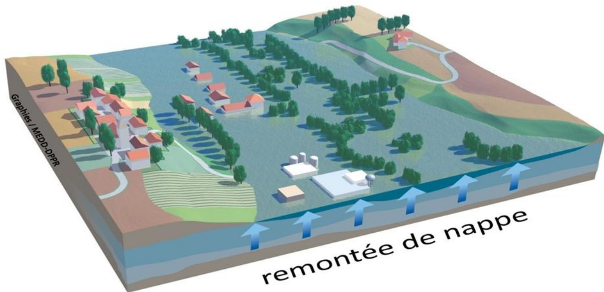
Figure I.5. Inondation par remontées des nappes phréatiques.
