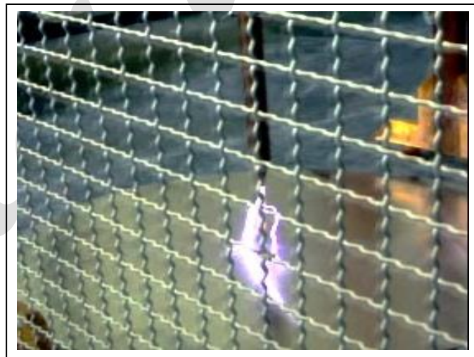
Figure I.8. Décharge directe sans barrière. Laboratoire de haute tension (HT) de l'université de Biskra.
