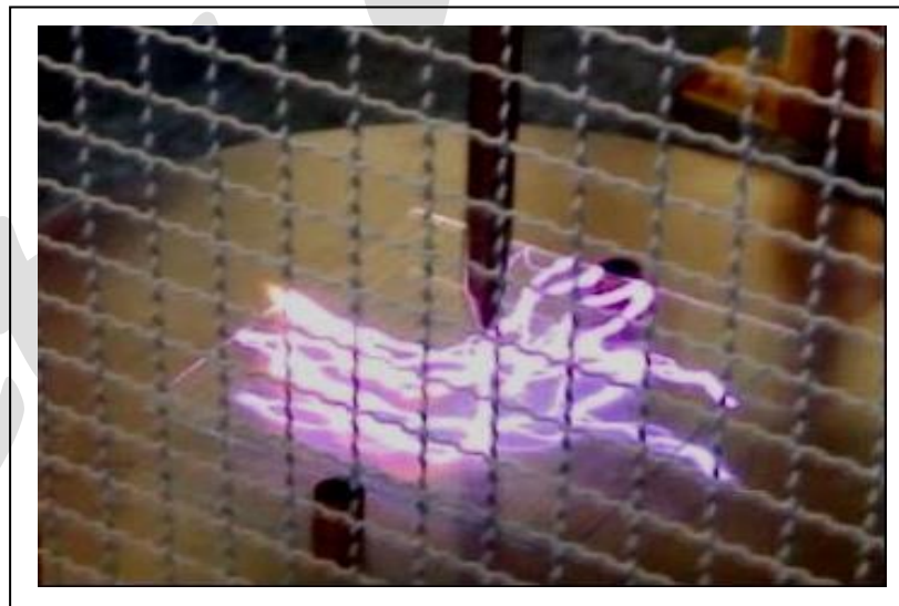
Figure I.9. Décharge glissante. Laboratoire de HT de l'université de Biskra.
