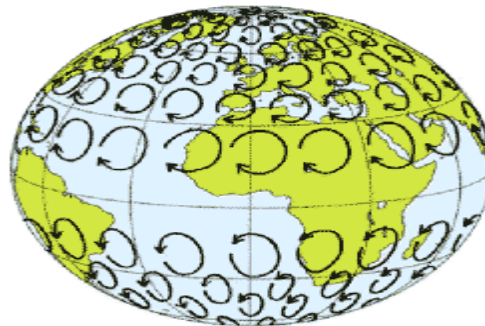
Figure (1-5) : Effet de la force de Coriolis sur la direction des vents
