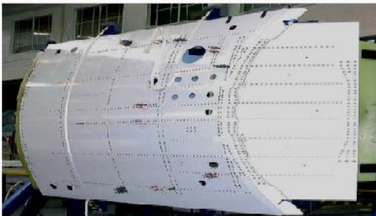
a. Photo réelle du fuselage riveté d'un avion,
