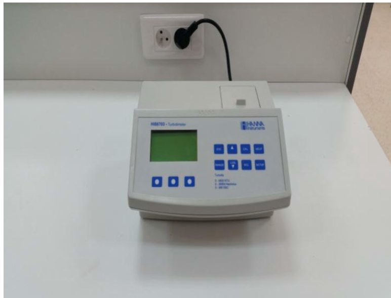
Figure. IV.3: Turbidimètre Hanna "HI88703"
