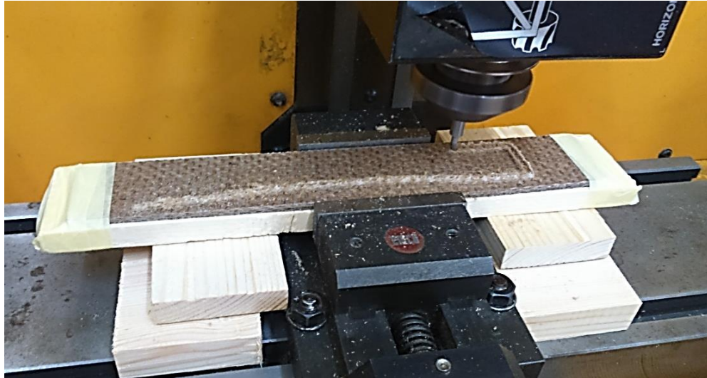
Figure IV. 14. Usinage d'éprouvette par CNC
