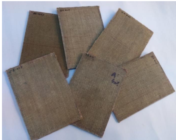
Figure IV.11. Les plaques de bio composite obtenues
