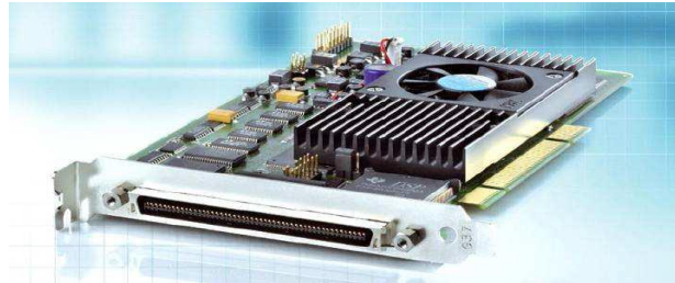
Figure (IV.17) : Vue extérieure de la plaque DS1104
