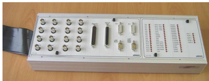
Figure (IV.18) : Panel d'interface CLP1104
