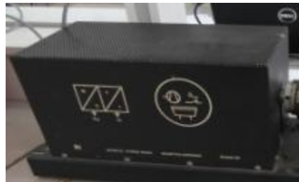
Figure (IV.13) : frein à poudre magnétique de type SE 2662 - 5R
