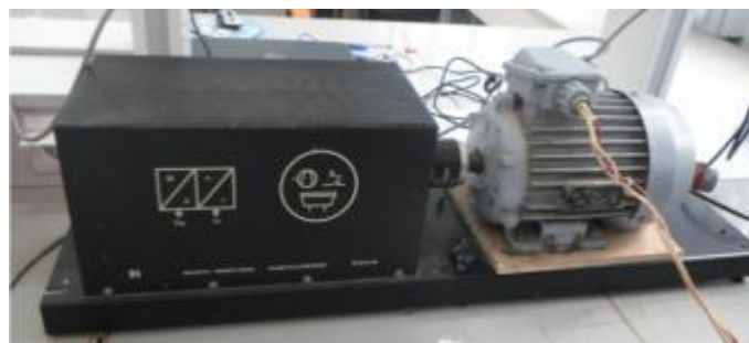
Figure (IV.14) : Moteur asynchrone couplé avec frein à poudre
