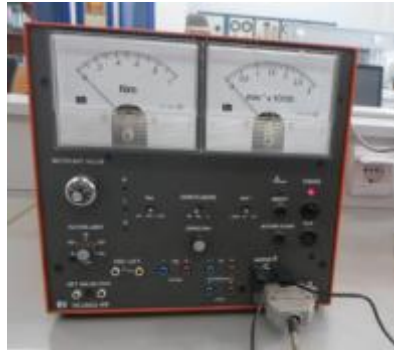
Figure (IV.15) : Contrôle du frein à poudre
