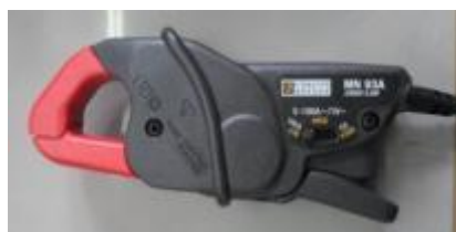
Figure (IV.11) : Capteur de courant de type MN-93A
