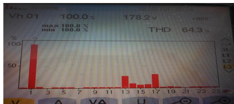
Figure V.76 : THD de tension d'un seul phase V_1 (pour m=15 ; r=0.86 )
