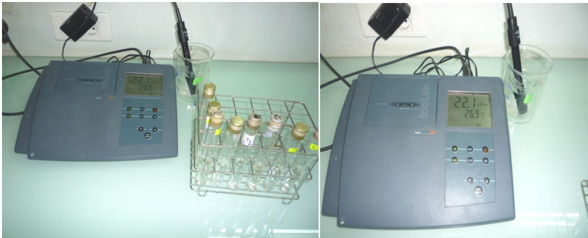
Figure VI-8 : Mesure la perméabilité membranaire des feuilles par la conductimètre
