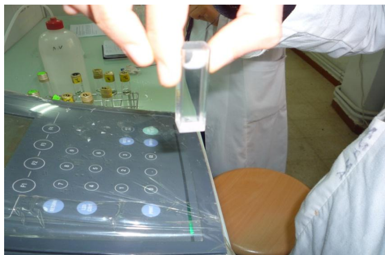
Figure09 : la lecture de la DO par spectrophotomètre.
