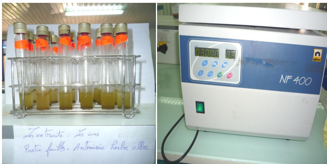
Figure VI-10: Centrifugation des extraits à 3000rpm pour dosages des ions
