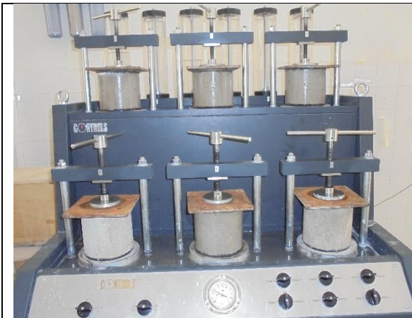
Figure IV.5 : Appareil de mesure de perméabilité à l'eau
