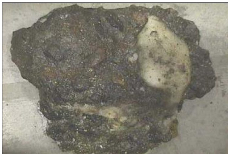
Figure III.6: Échantillon d'un béton exposé à un environnement très agressif de sulfate de magnésium
