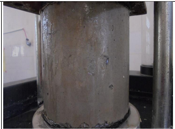
Figure IV.6 Ecoulement d'eau sous pression vers l'extérieur de l'éprouvette
