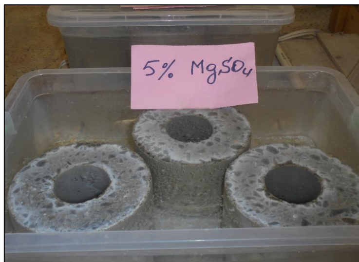
Figure IV.33 : Bétons conservés dans la solution acide 5% de MgSO_4
