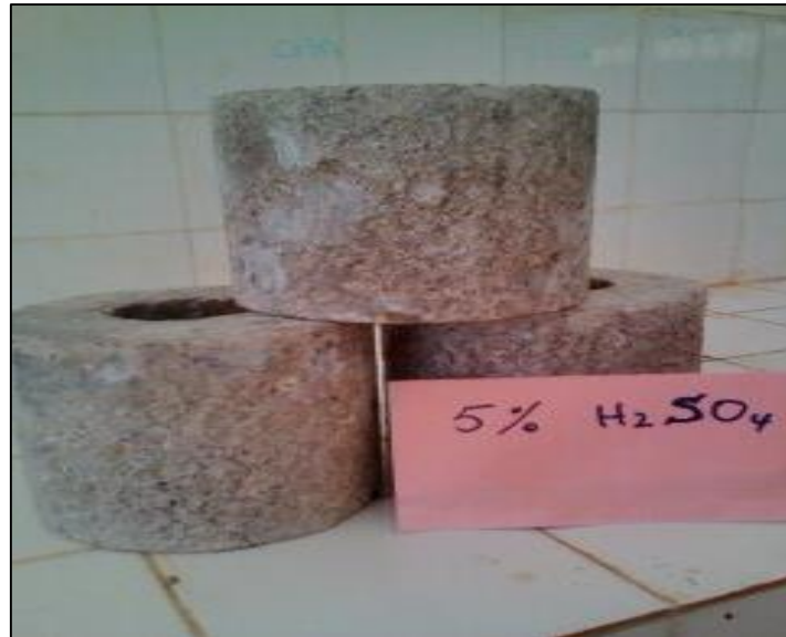
Figure IV.31: Dégradation des surfaces des éprouvettes sous l'effet de H_2SO_4
