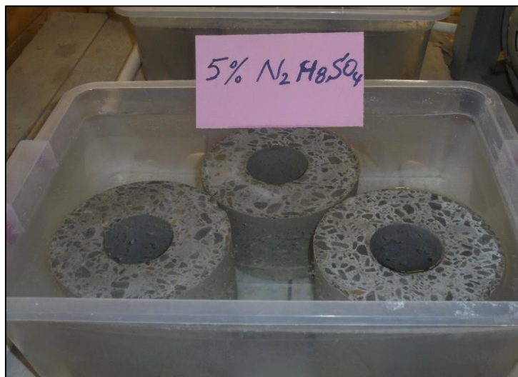
Figure IV.32 : Bétons conservés dans la solution acide 5% de (NH_4)_2 SO_4 .
