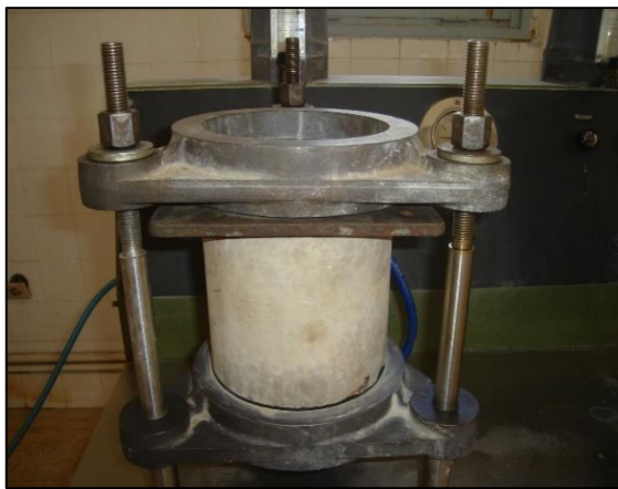
Figure II.10 : principe de fixation des éprouvettes cellules de l'appareil de perméabilité
