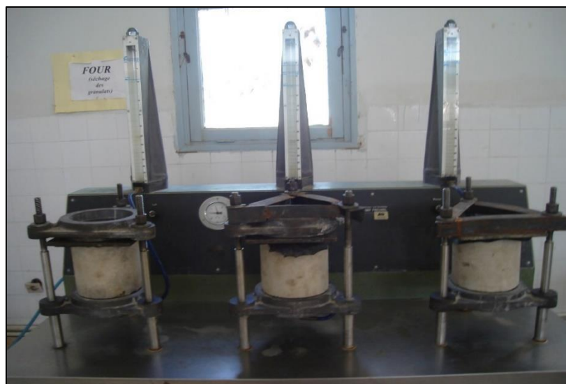
Figure II.9 : perméabilimètre à trois cellules (Laboratoire du développement des Géomatériaux – université de Msila)
