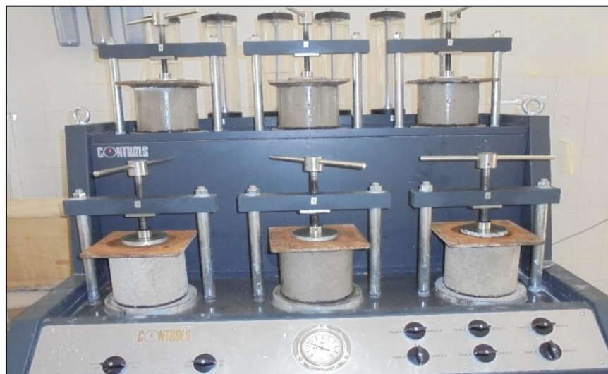
Figure II.12 : perméabilimètre permettant les tests de six éprouvettes
