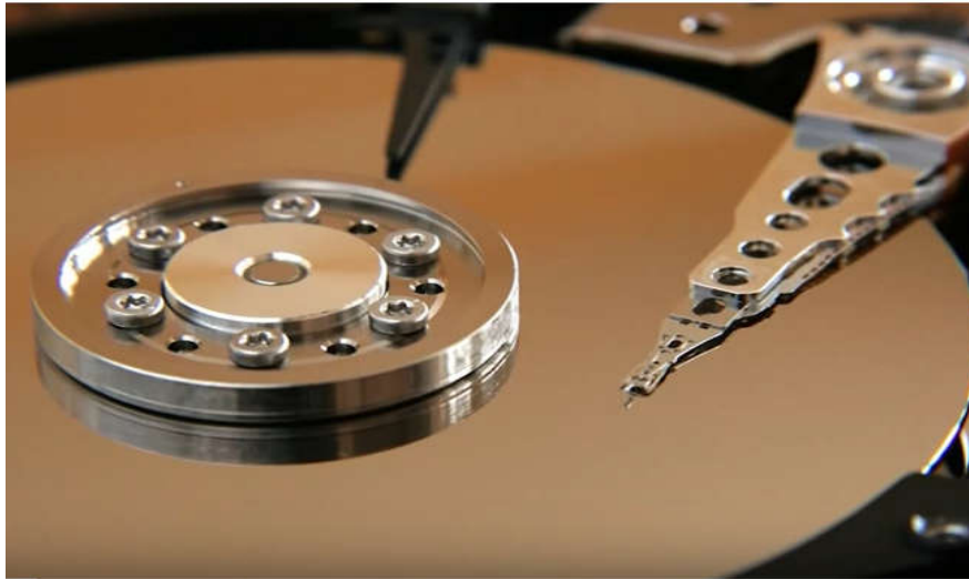
Figure. II.6: Détail d'un bras avec sa tête reposant sur un plateau de disque dur.
