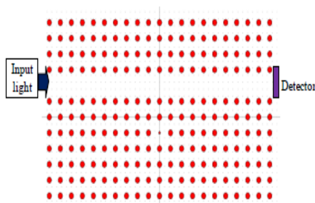
Figure 2.16 : Le capteur de pression proposé par S.Olyaei et al [42]
