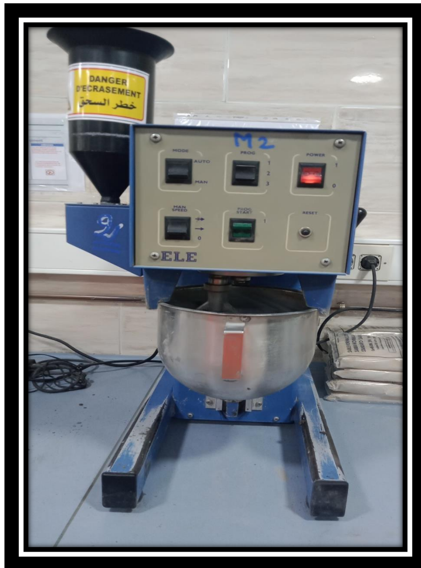
Figure. III.11 Malaxeur semi-automatique de mortier (Laboratoire de Lafarge M'sila).
