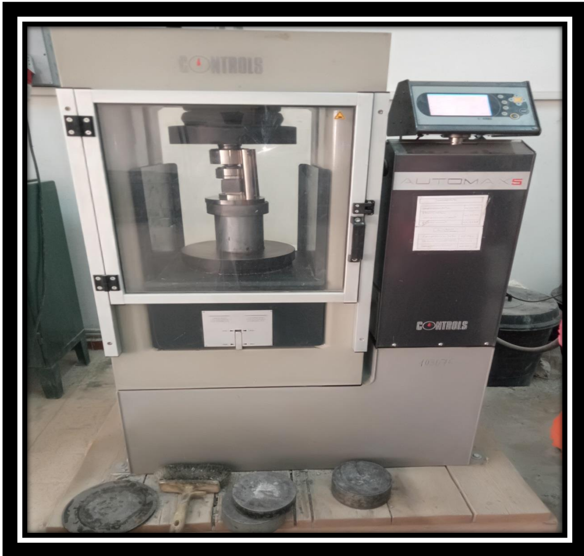
Figure .III.17 L'appareil de résistance à la compression.
