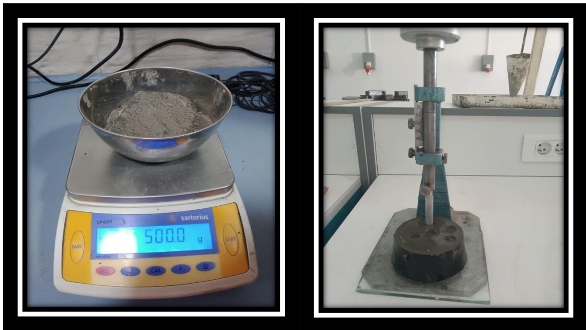
Figure .III.9. L'essai de consistance de ciment.
