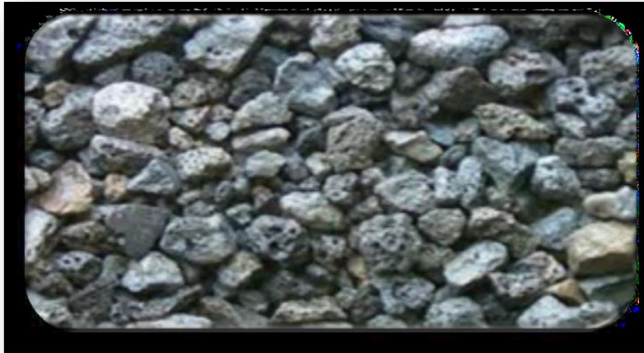
Figure.II.4 Laitier de haut fourneau. [31]
