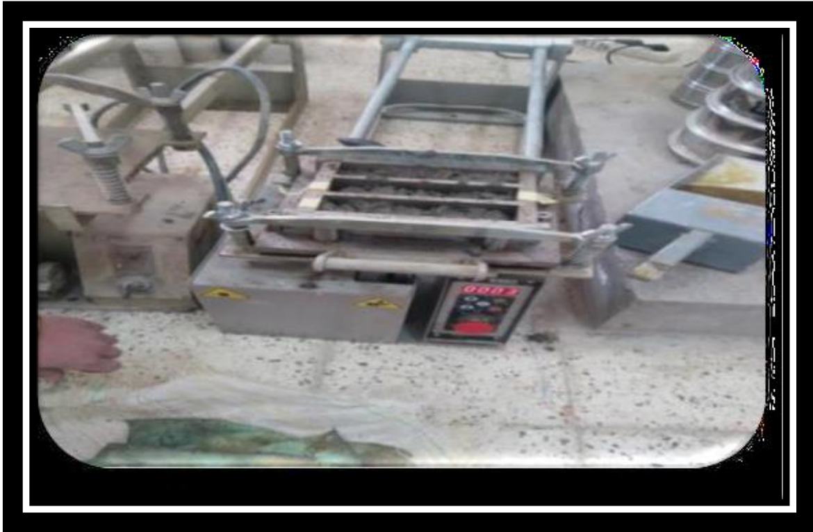
Fig.III.13 Table vibrante (table à choc).
