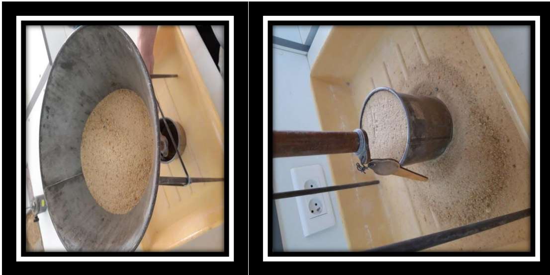
Figure.III.2. .La masse volumique apparente (labo de génie civil).
