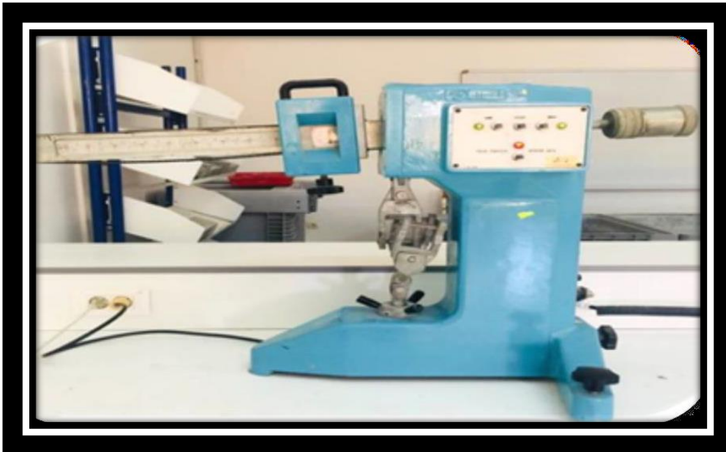
Figure .III.14 L'appareil de résistance à la flexion.
