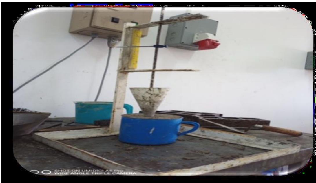
Figure.III.10 Cône d'affaissement du mortier
