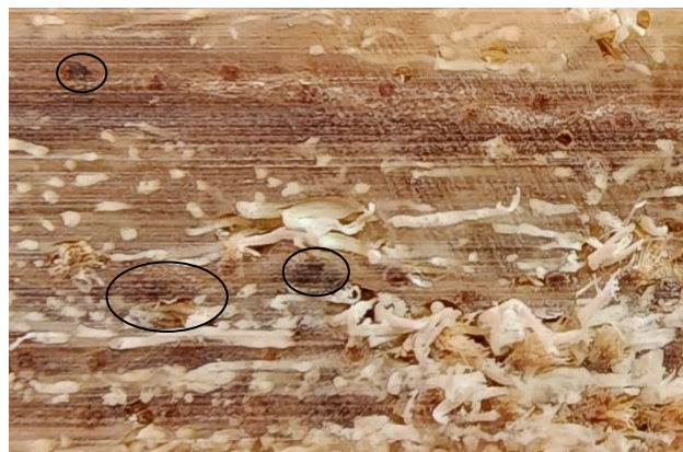
Figure 3 2: Dommages thermique de la matrice et des fibres.
