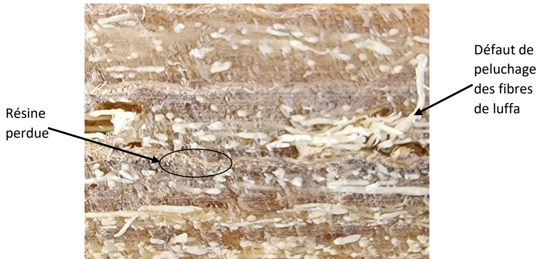
Figure 3 1: Image des défauts d'usinage rencontrés lors du détourage Composite de fibres Luffa/Jute
