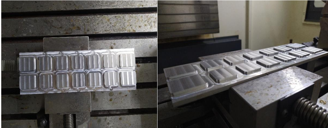
Figure 2 6: Gabarit pour fixer les échantillons durant l'usinage
