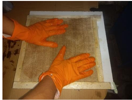
Figure 2 4: Superposition des Couches(luffa/jute) avec la résine
