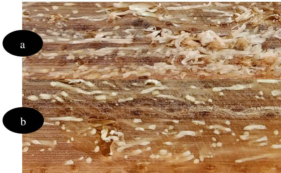
Figure 3.4: Mode de fraisage en avalant et mode de fraisage en opposition lors d'une coupe perpendiculaire à la fibre, a) Mode de détourage en opposition perpendiculaire à la fibre, f=0.14\text{mm/rev} et V_c = 100\text{m/min} , b) Mode de détourage avalant perpendiculaire à la fibre, f=0.14\text{mm/rev} et V_c = 100\text{m/min}
