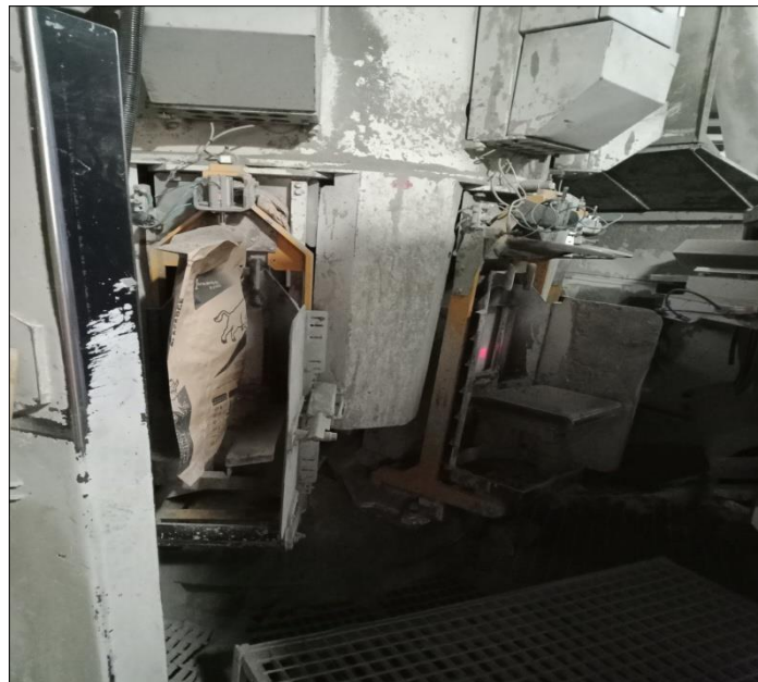
Figure II-7: Applicateurs de sac pour remplissage du ciment [9].
