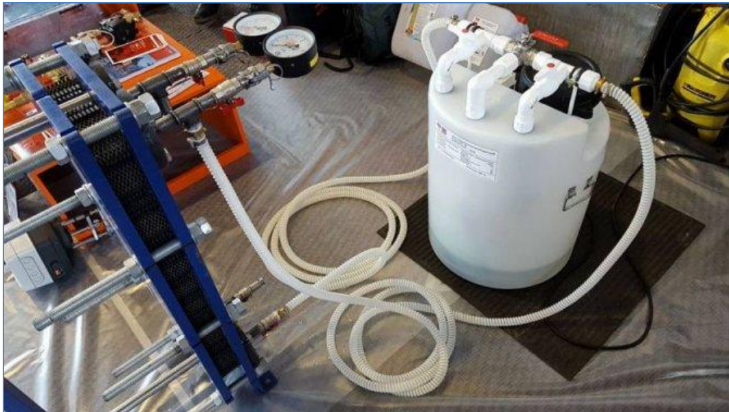
Figure III .12: Dispositif de nettoyage chimique des échangeurs de chaleur à plaque [26]
