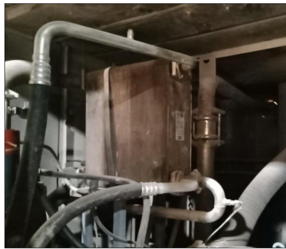
Figure II.19: Échangeur de chaleur a trois circuits [9].
